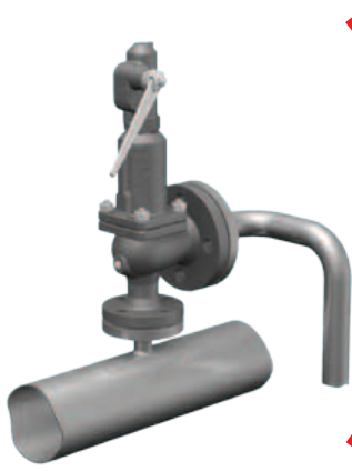
Правильная установка для воды и сжатого воздуха
