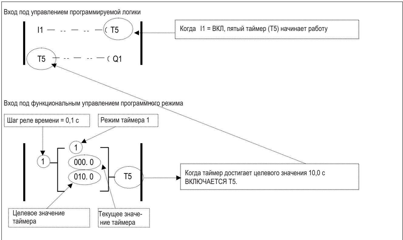
Режим таймера 2 (ВКЛ-Режим задержки В)
