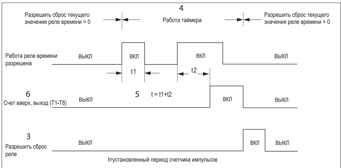
Режим таймера 3 (ВЫКЛ-режим задержки А)
