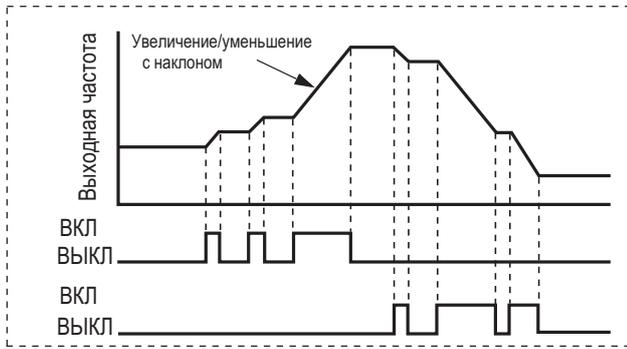
В окне 5-11 = 4, частота зависит от входной частоты режима последовательной связи.
