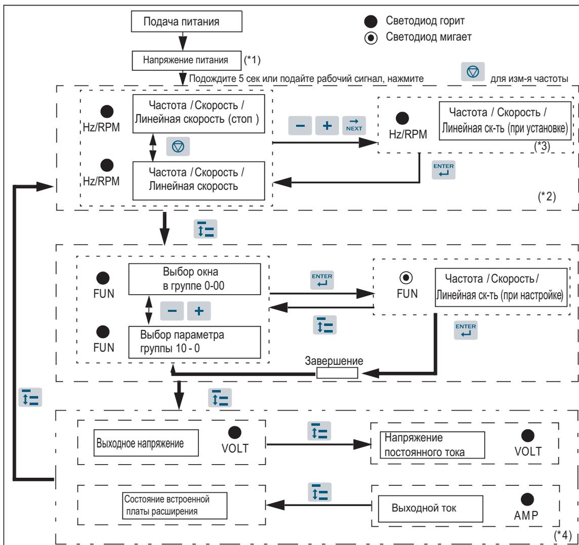
\*1: Текущее значение напряжения, в окне 0-07, будет показано на дисплее после подключения преобразователя.
