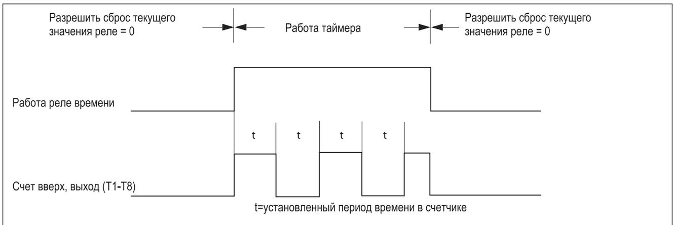
Режим таймера 6 (Импульсно-ступенчатый режим В)
