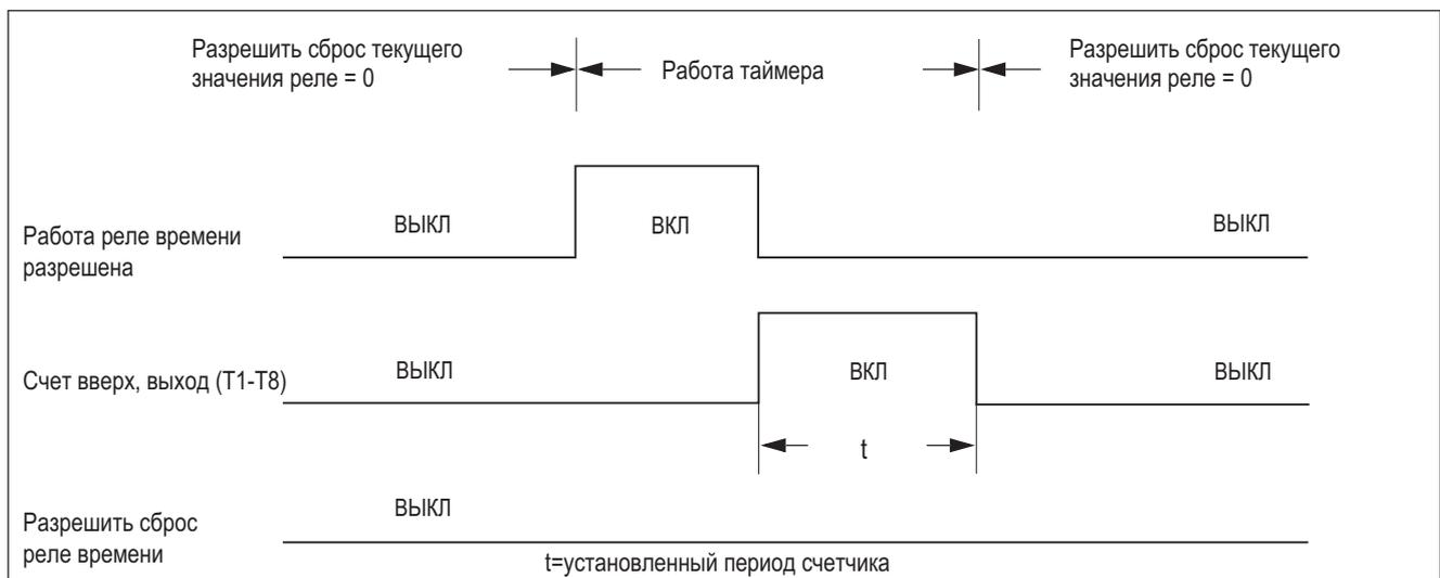
Режим таймера 5 (Импульсно-ступенчатый режим А)
