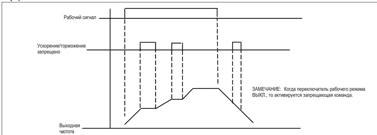
Внешний переключатель клемм ВЫКЛЮЧЕН: Окна 1-00/01 определяют источник сигнала на пуск и сигнал по частоте.
