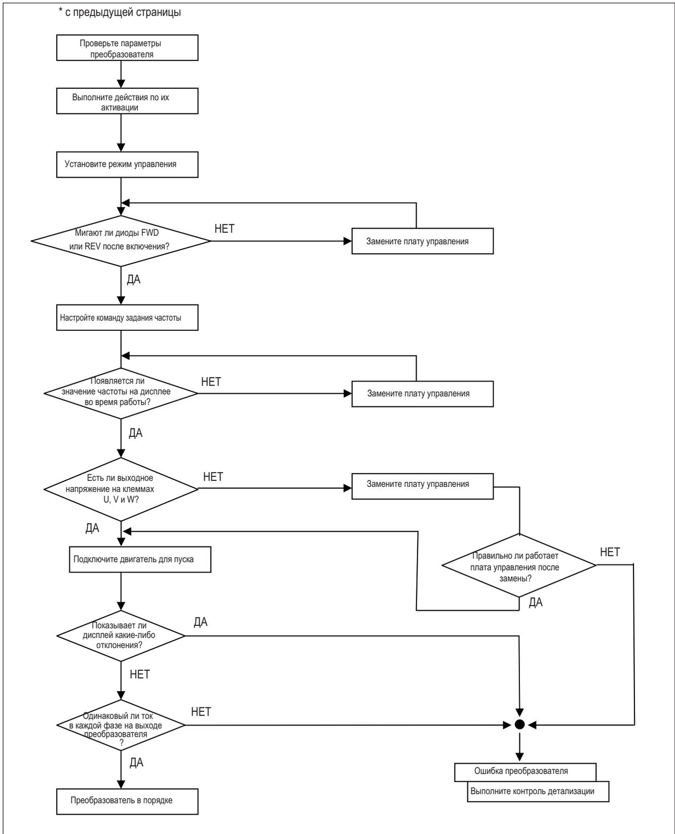
Устранение неисправностей ОС, OL, высвечиваемых на дисплее
