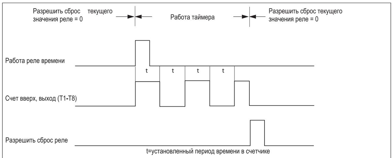
Режим таймера 7 (Импульсно-ступенчатый режим С)
