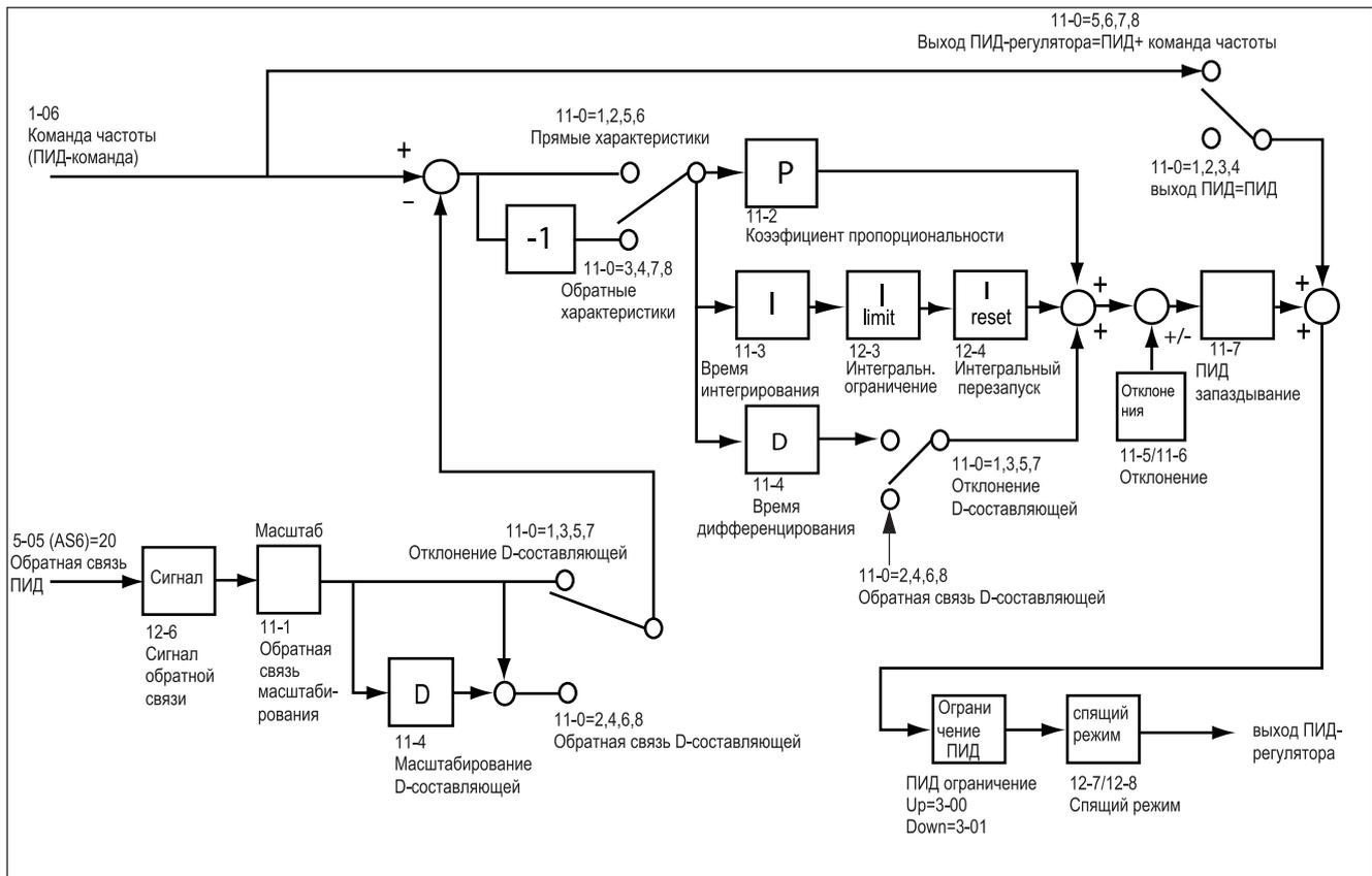
1. Для выполнения ПИД-регулирования, установите 5-05 = 20, AI2 (S6) на клеммном блоке TM2 как сигнал обр. связи ПИД-регулирования.
