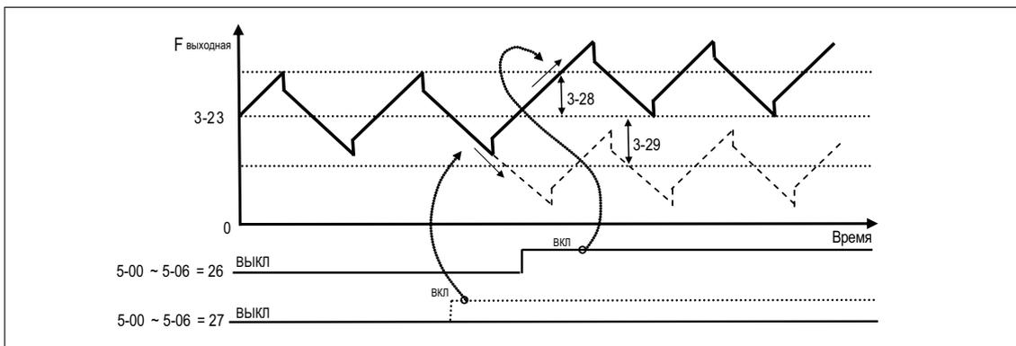
4. Диапазон частоты пилообразного режима ограничен верхними и нижними пределами. Т.е. если «центральная частота + амплитуда» больше верхнего предела, то преобразователь будет работать на высшей частоте. А если «центральная частота - амплитуда» меньше нижнего предела, то наоборот.
