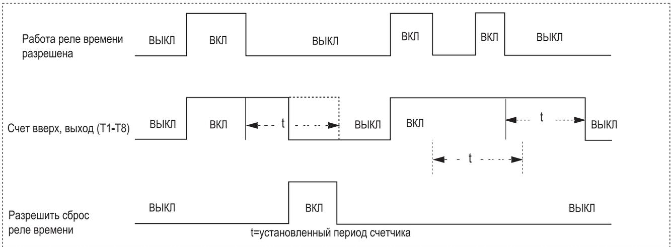
Режим таймера 4 (ВЫКЛ- режим задержки В)
