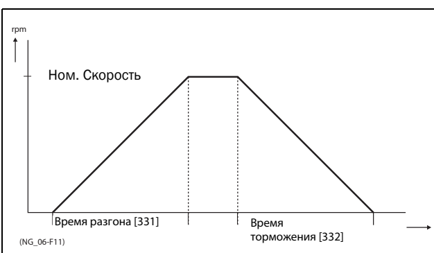
Рис. 91 Время разгона и торможения
