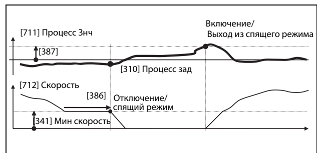
Рис. 105 Отключение/спящий режим ПИД при инвертированном ПИД-регулировании
