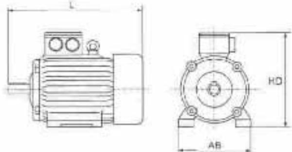
Значения в таблице указаны в зависимости от типа используемого двигателя. Асинхронный электроодвигатель типа IMB3, со степенью защиты IP54 и выше, изоляция класса F и выше.
