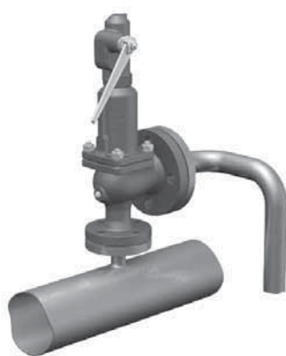
Правильная установка для воды и сж. воздуха
